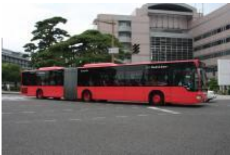
試験走行を行った連節バス
